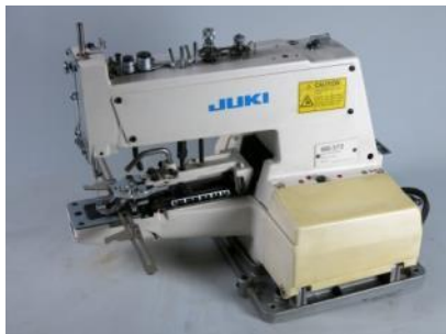
Màquina per cosir botons. C.1980. «Juki Corporation» (Japó) Ferro i acer. 36 x 41 x 29 cm. MdM 16533
